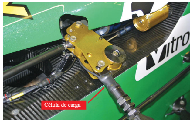
Figura 29: Célula de carga instalada no tubo de alavanca da suspensão (MCBEATH, 2017)
