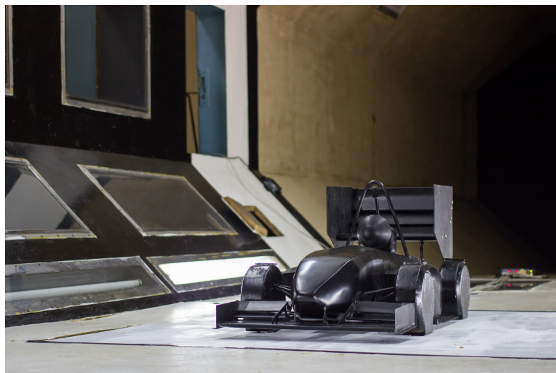
Figura 25: Teste em Túnel de Vento com modelo em escala (KONELEK, 2016)
