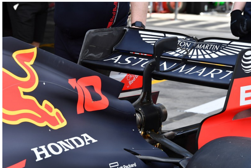
Figura 14: Asa traseira de um carro de Fórmula 1 (TECHNICAL, 2019)
