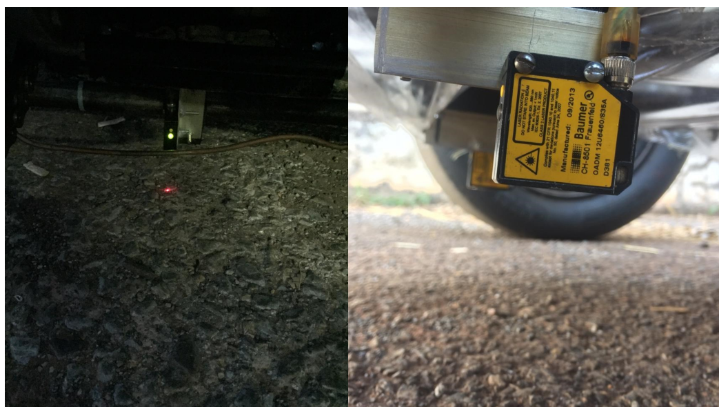
Figura 31: Sensores laser instalados.
