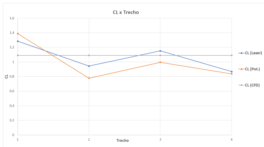
Figura 57: Coeficiente de Downforce por trecho: Comparação entre os métodos de medição
