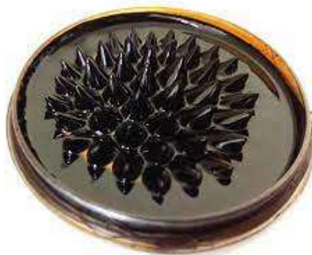
Figura 1: – Observação macroscópica de um ferrofluido interagindo com um campo magnético externo.
