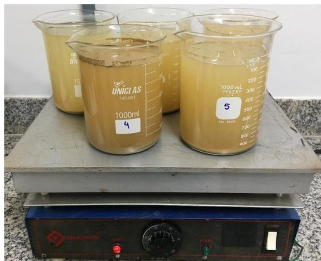
Figura 6 - Amostras de solo com água secando em mesa secadora
