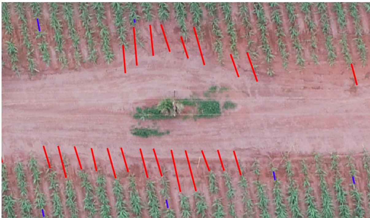
Figura 4.15: Falhas detectadas pelo nos fins das linhas pela aplicação (vermelho) e falhas detectadas pelo INFOROW (azul)
