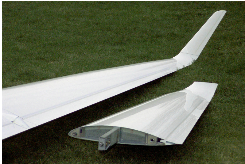
Figura 13 – O aerofólio de um planador ASW 28-18 visível como um corte transversal na asa (MüNCH, 2021)
