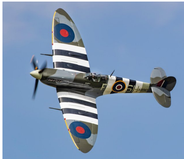
Figura 20 – Supermarine Spitfire e suas asas elípticas (CROWN, 2021)
