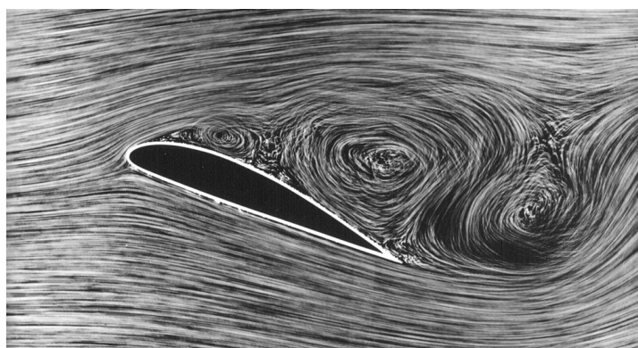
Figura 70 – Experimento em túnel de vento demonstrando a separação do ar sobre um aerofólio ( WIKIPEDIA, 2021a )
