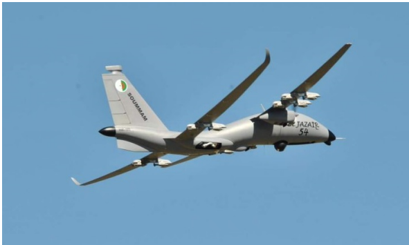
(a) Yabhon United 40 e suas asas de alta razão de aspecto em configuração tandem (ZIA-DEH, 2021)
