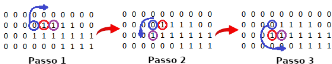
Figura 5 – Primeiro pixel do contorno em vermelho. Busca feita no sentido horário. Último pixel do contorno em roxo.
