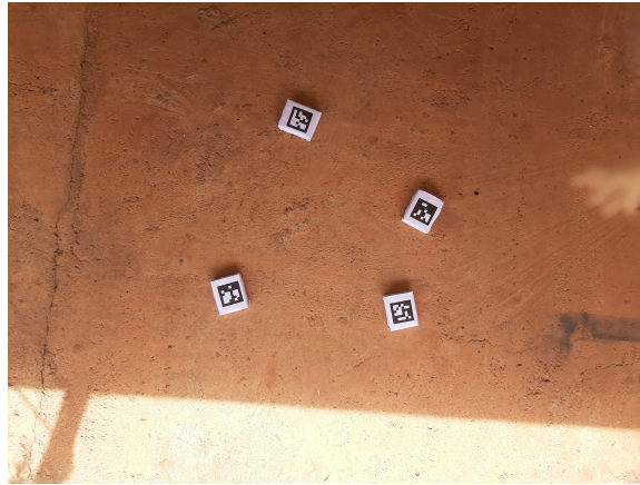
Figura 12 – Imagem da base de dados com marcadores ArUco com iluminação solar.
