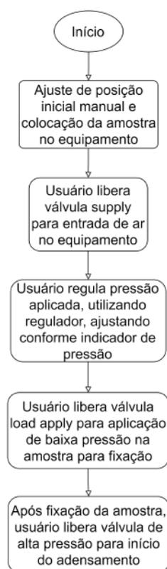
Figura 9 – Fluxograma de funcionamento - equipamento - parte 1 (Autoria própria, 2021)
