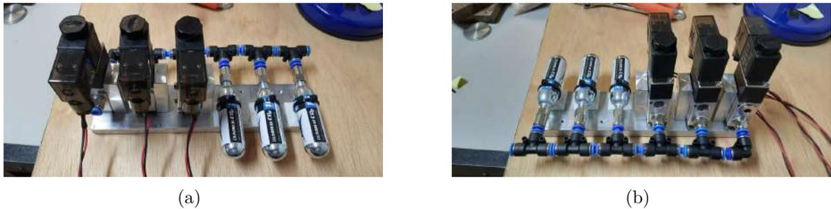
Figura 73 – Pneumática - Válvulas e Reservatórios (Autoria própria, 2022)
