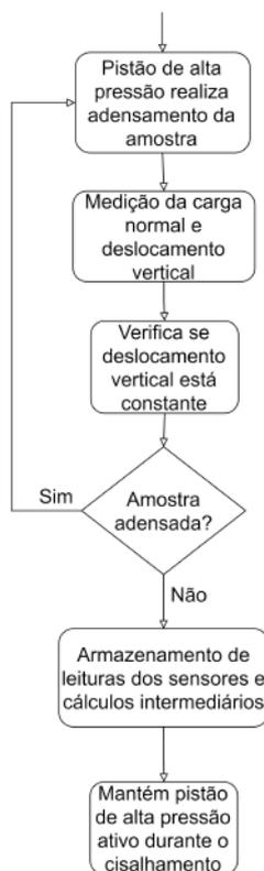
Figura 10 – Fluxograma de funcionamento - equipamento - parte 2 (Autoria própria, 2021)
