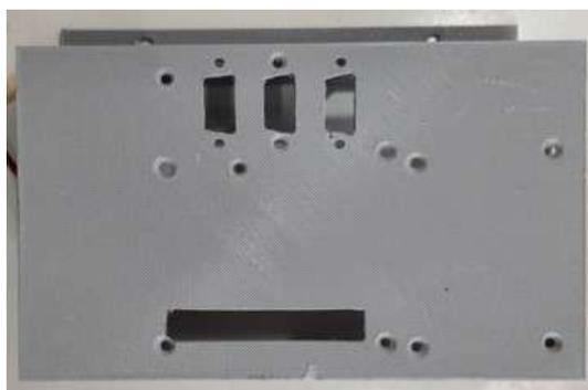
Figura 66 – Impressão 3D - Caixa de Eletrônicos (Autoria própria (2022))
