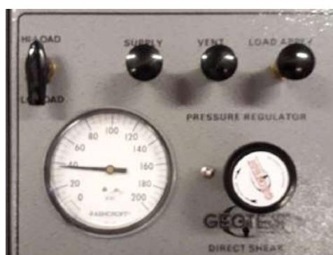
Figura 26 – Pneumática - Válvulas Manuais (Autoria Própria, 2022)
