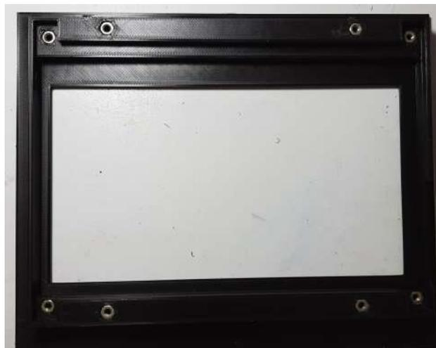
Figura 65 – Impressão 3D - Visão Traseira da Moldura da Tela (Autoria própria (2022))
