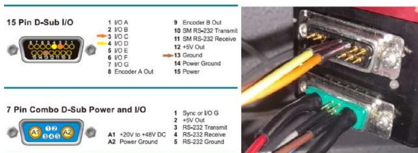
Figura 17 – Conexões do servo motor - Adaptado (ANIMATICS, 2002b)
