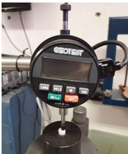
Figura 20 – Foto do sensor de deslocamento (Autoria Própria, 2021)
