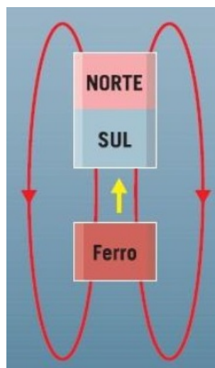
Figura 6 – Levitação eletromagnética (Fonte: GOMES; STEPHAN 2004)
