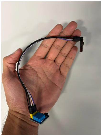
Figura 27 – Módulo Sensor DHT11 ligado à ESP01
