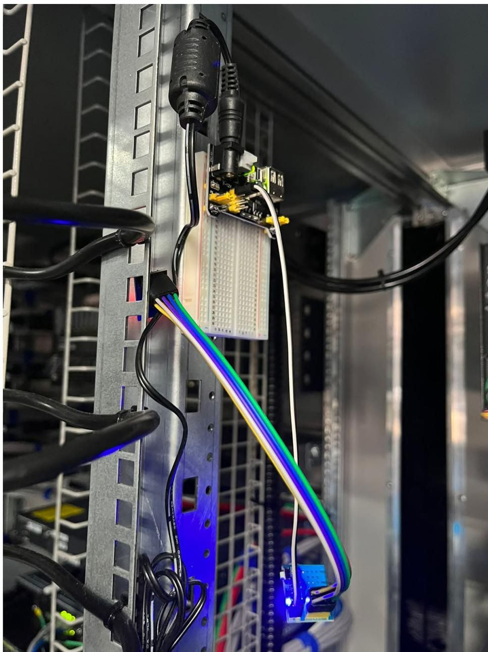
Figura 29 – Módulo Sensor DHT11/ESP01 instalado no Servidor
