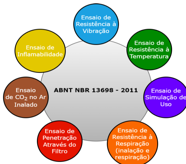
Figura 11: Ensaios estabelecidos ABNT NBR 13698 DE 2011 para verificar a eficiência de um respirador, de acordo com ensaios mecânicos.
