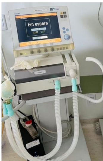
Figura 18: Ventilador pulmonar, utilizado como gerador de fluxo de ar contínuo.
