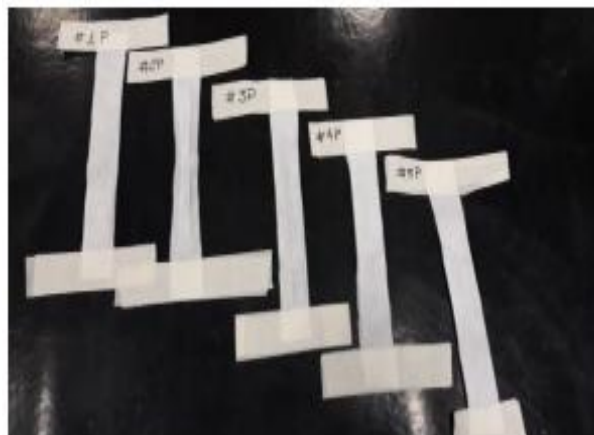
Figura 12: Corpos de prova, retirados dos respiradores Vesta para realização dos ensaios de tração, ensaio de rasgamento, de gramatura, ensaio termográfico e avaliação por microscopia.
