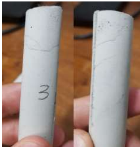
Figura 32 - Fissuras no corpo de prova. Fonte: Autoria própria
