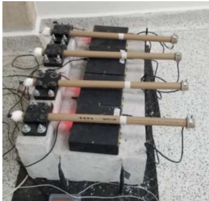
Figura 19 - Esquema completo do ensaio EMM-ARM.
