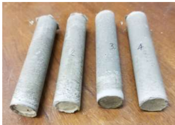
Figura 44 - Corpos de prova - Argamassa – Sonelastic. Fonte: Autoria própria
