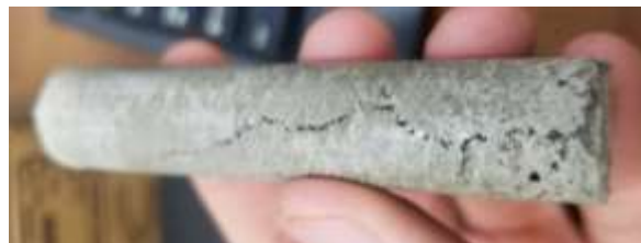
Figura 45 - Demonstração de vazios - Argamassa – Sonelastic. Fonte: Autoria própria
