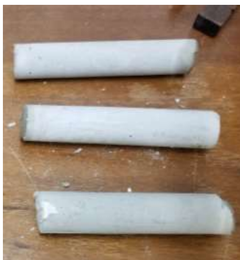
Figura 24 - Amostras para o ensaio Sonelastic. Fonte: Autoria própria
