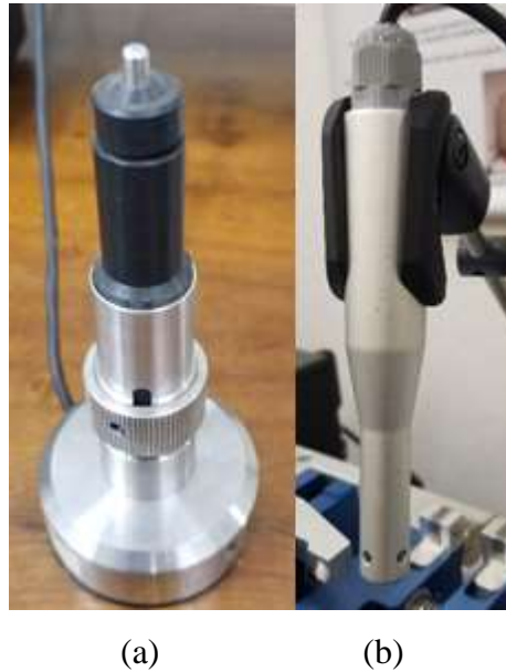
Figura 25 - Sonelastic – (a) Pistão e (b) microfone. Fonte: Autoria própria
