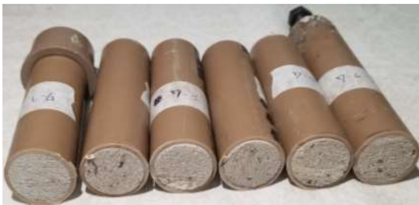
Figura 55 - Corpo de prova serrado – Argamassa. Fonte: Autoria própria
