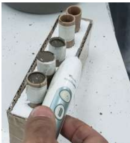
Figura 17 - Processo de vibração das amostras para ensaio de Sonelastic.
