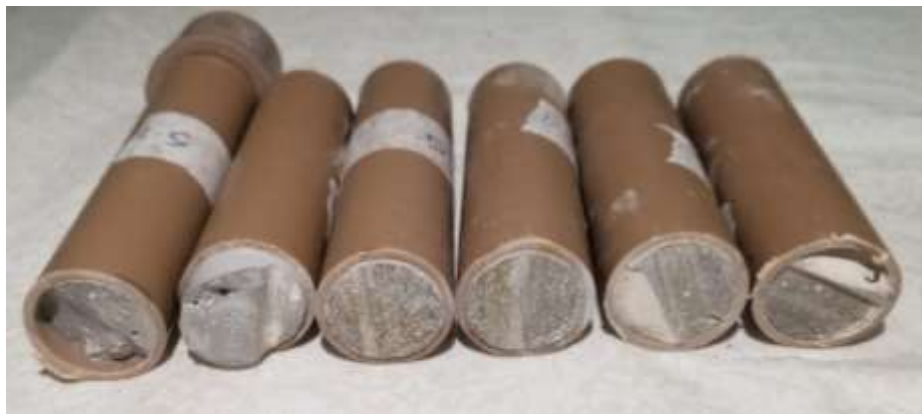
Figura 41 - Seções serradas do tubo – Pasta. Fonte: Autoria própria
