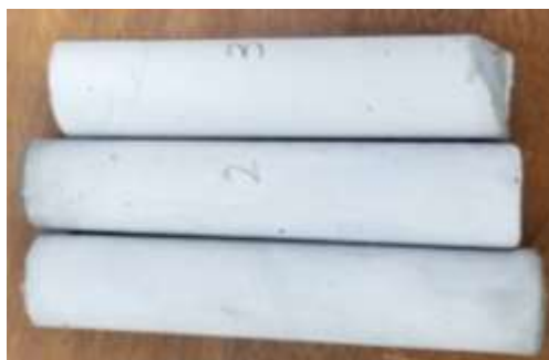
Figura 30 - Corpos de prova - Pasta – Sonelastic. Fonte: Autoria própria
