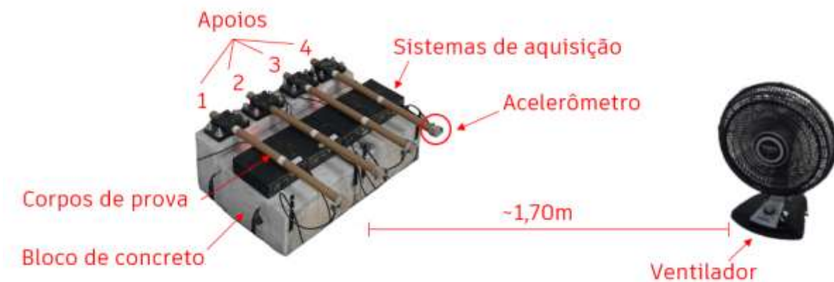
Figura 13 - Configuração do ensaio EMM-ARM para pastas de cimento.
