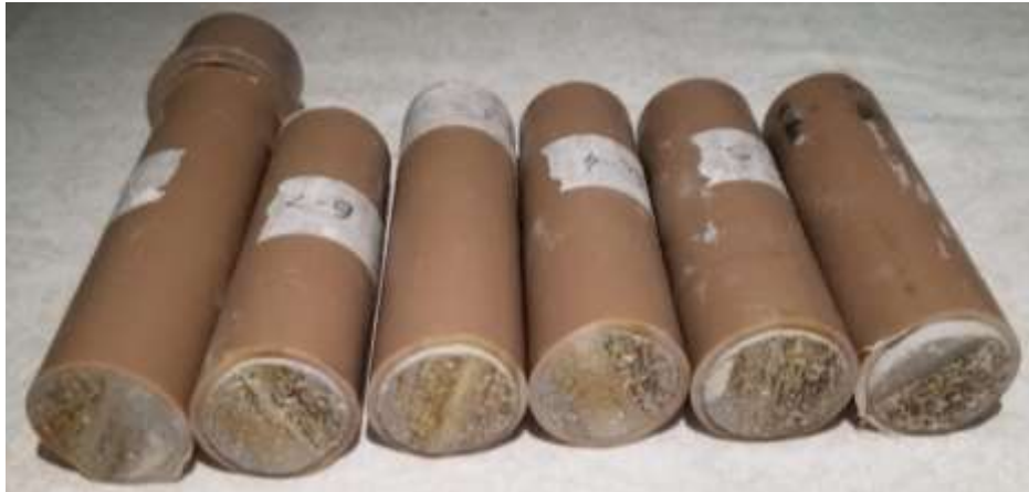
Figura 43 - Seções serradas do tubo - Pasta (II). Fonte: Autoria própria
