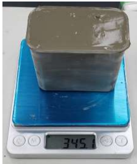
Figura 16 - Pesagem da amostra para determinação da densidade da pasta.
