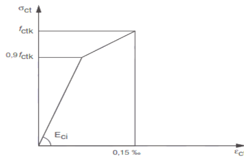
Figura 7. Diagrama tensão-deformação bilinear de tração. (NBR 6118:2014).
