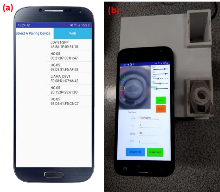
Figura 9: (a) Tela de pareamento com o mini-titulador e (b) posicionamento correto do smartphone com enquadramento no reator.
