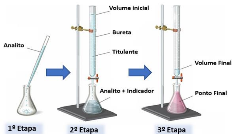
Figura 1: Ilustração com os aparatos e etapas envolvidas em uma titulação volumétrica. 1º Etapa: preparação da amostra e adição do indicador, 2º Etapa: titulação com agente titulante, 3º Etapa: Fim da titulação com a mudança de cor da solução. Adaptado de RD RESOLUÇÕES: https://www.passeidireto.com/arquivo/70561226/titulacao .
