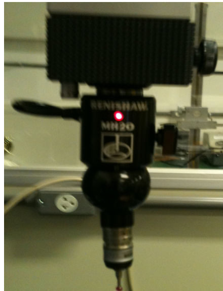
Figura 2.3: Apalpador articulado utilizado na MMC.
