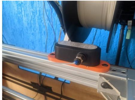
(b) Peça fabricada com impressão 3D para acoplar o sensor de filamento inteligente ao sistema.
