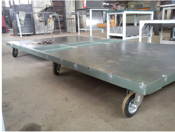
Figura 3.21 - Solda da chapa para distribuição de peso.
