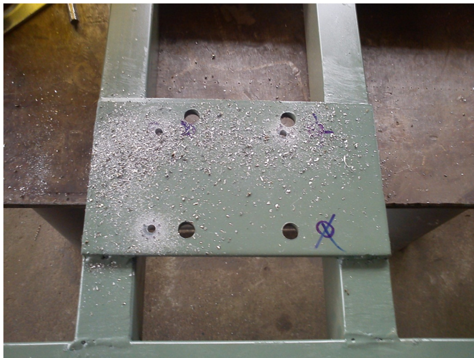
Figura – Execução de furos no suporte para fixação dos rodízios.
