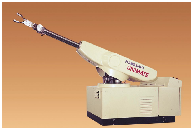
Figura 1 – Primeiro Robô Manipulador - Unimate
