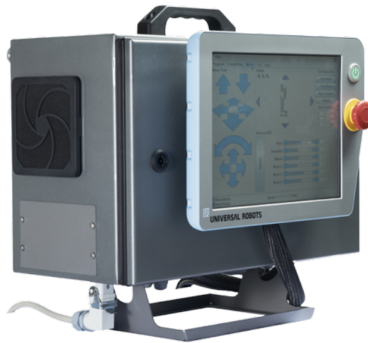
Figura 3 – Caixa de Controle do sistema.
