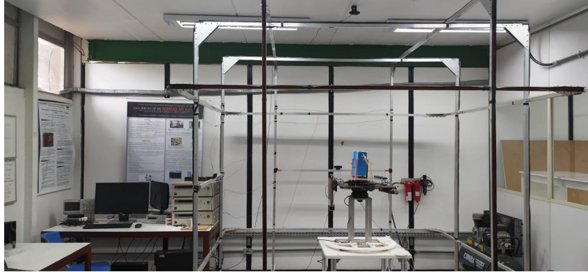
Figura 47 – Gaiola de Helmholtz, conjunto mockup e mesa montados no mancal a ar, e computador utilizado para comunicação com o RaspberryPi (a esquerda).
