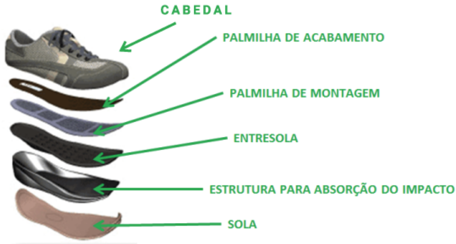
Figura 10: Estrutura básica de um sapatênis Fonte: Medicofisiatra (2022)
