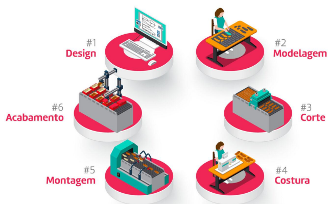
Figura 9: Fluxograma do processo de fabricação de um calçado Fonte: Daniel Atacado (2022)
