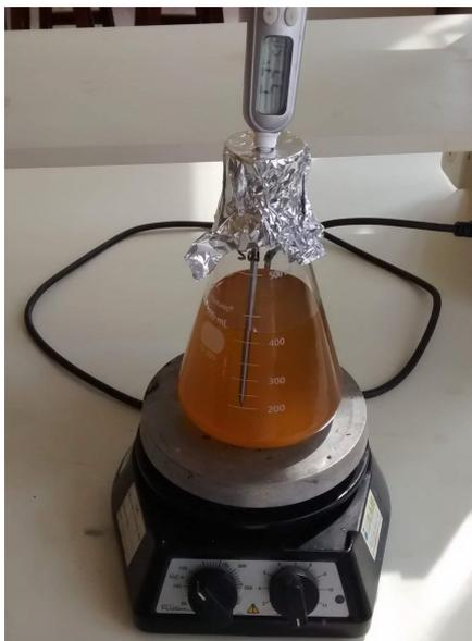
Figura 5 – Amostra da preparação de biodiesel de soja após o término da reação de transesterificação.
