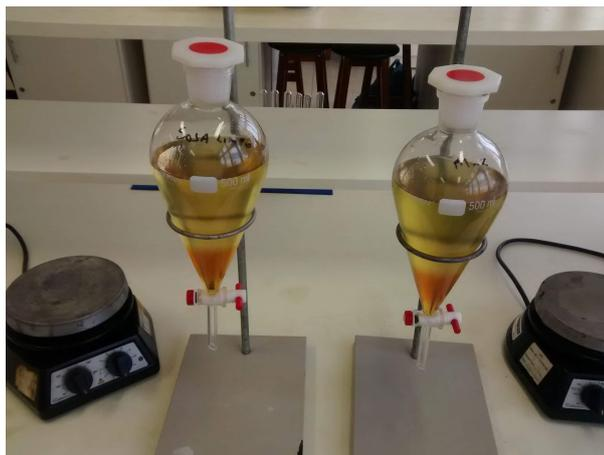
Figura 8 – Amostra da preparação de biodiesel de macaúba e soja, sem utilização, após o processo de decantação. Fonte: Autor.
