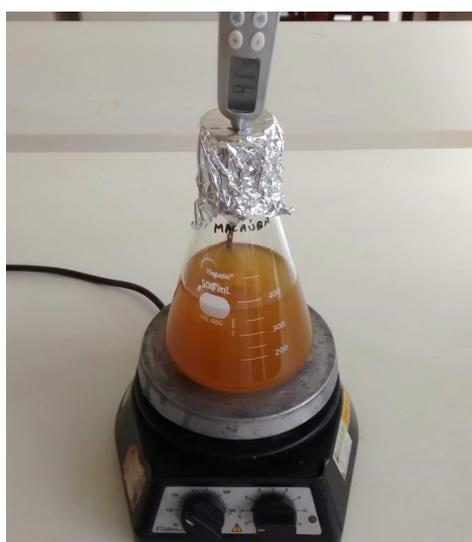
Figura 6 – Amostra da preparação de biodiesel de macaúba após o término da reação de transesterificação.
