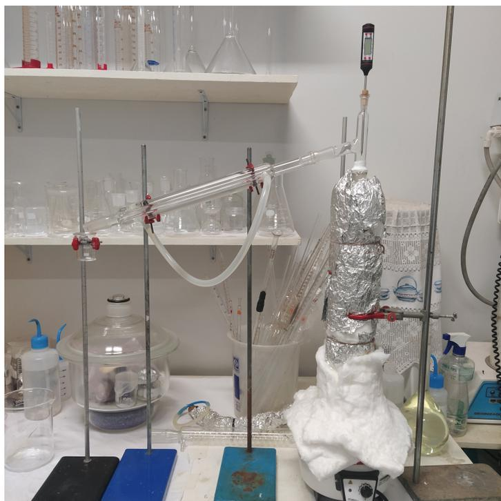
Figura 10 – Sistema de destilação composto por manta térmica, coluna revestida com lã de vidro e papel alumínio, junta de conexão, termômetro e condensador.
