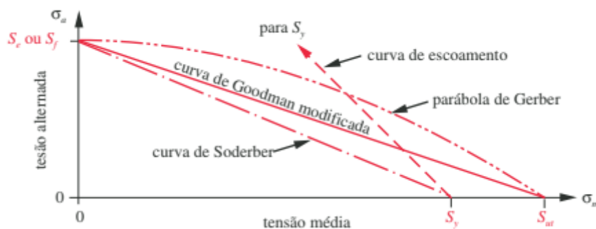
Figura 24 – Curvas de falha para tensões pulsantes. Fonte: (NORTON, 2013).
