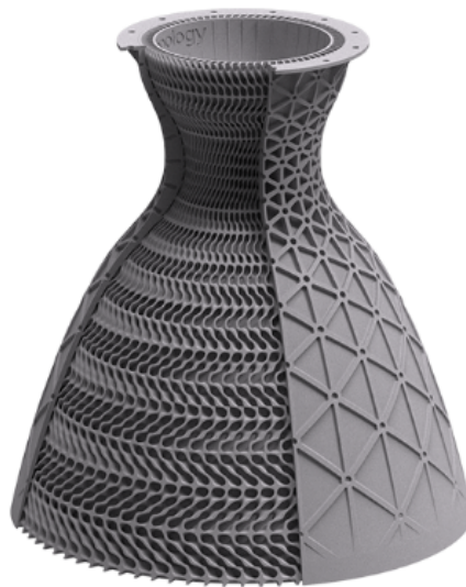
Figura 6.12 – Câmara de combustão feita no software nTopology com estruturas treliçadas e TPMS.
