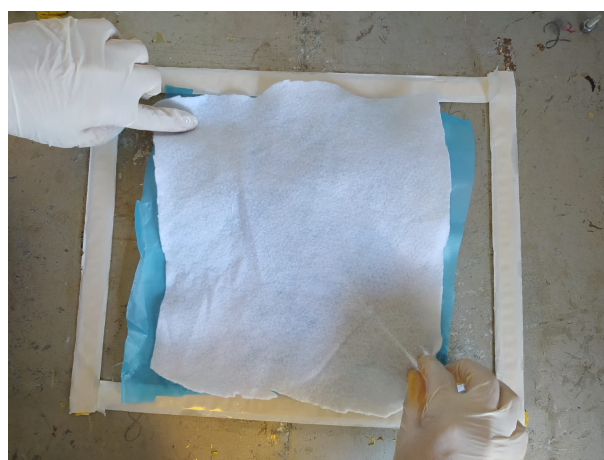
Figura B.5 – Aplicação do(a) Peelply . (b) Filme perfurado. (c) Sangrador.
