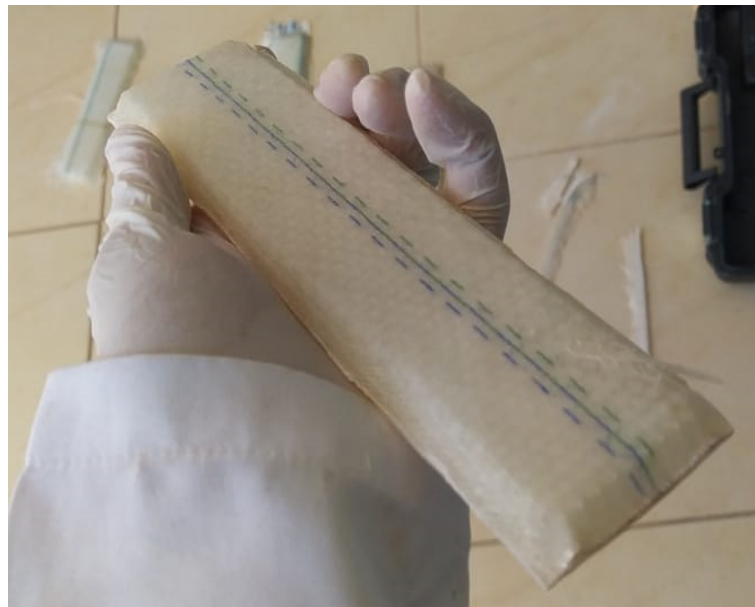
Figura 8.1 – Corpo de prova antes da retirada do excesso de material.
