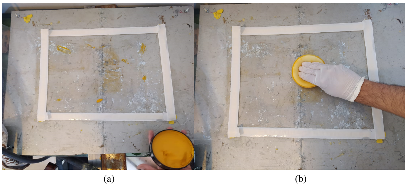
Figura B.1 – (a) Delimitação da área de laminação. (b) Aplicação da cera de carnaúba. Fonte: Autor
