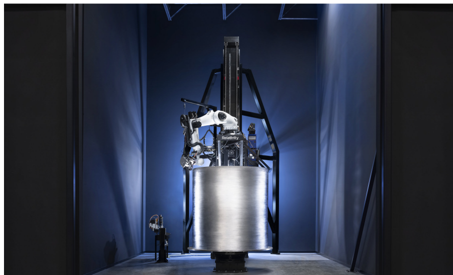
Figura 2.4 – Impressão de tanque de propelente pela empresa Relativity Space . Fonte: Space (2022)
