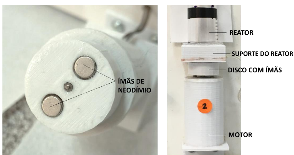
Figura 6 - Disco fabricado em PLA contendo dois ímãs de neodímio e fixado ao eixo do motor
