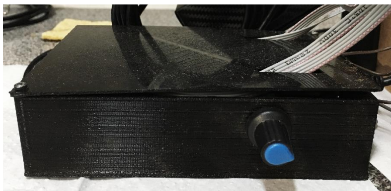
Figura 8 - Compartimento de PLA fabricado para acondicionamento do circuito eletrônico
