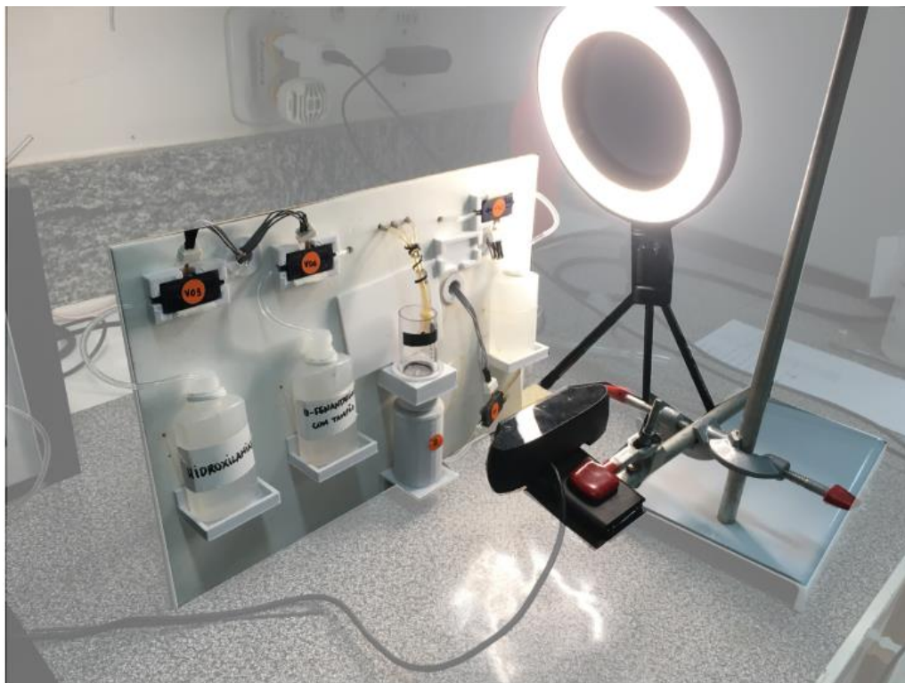
Figura 15 - Iluminador do tipo ring light posicionado lateralmente ao sistema para realização das medidas
