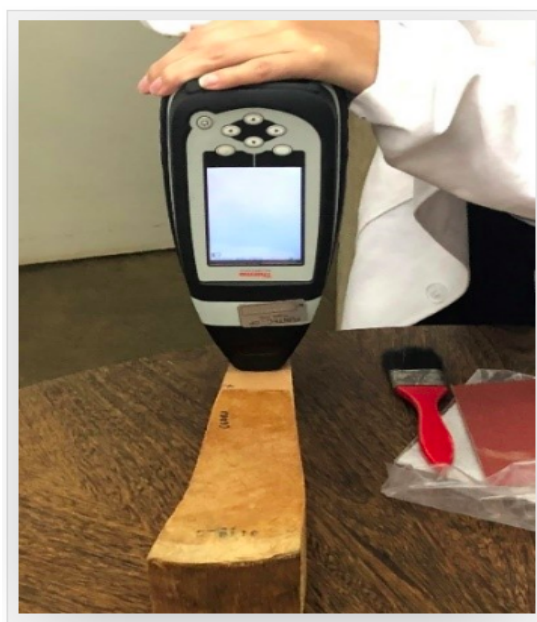
Figura 5 - Aparelho NIRS em teste na identificação de madeira.
