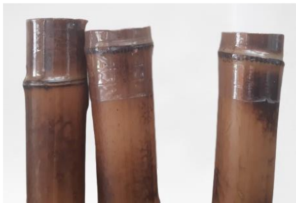
Figura 5. Detalhe dos lacres de garrafa PET como proteção das extremidades dos colmos.
