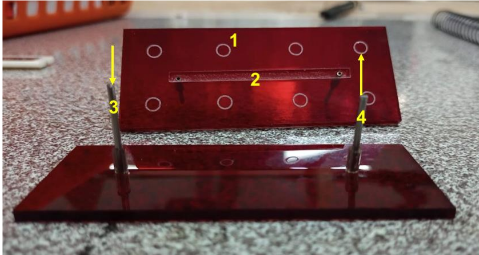
Figura 10: Célula de difusão desmontada. (1) Marcações de alinhamento. (2) Sulco. (3 e 4) Agulhas para entrada e saída do fluxo. Como a célula é simétrica, não há diferença entre 3 e 4.
