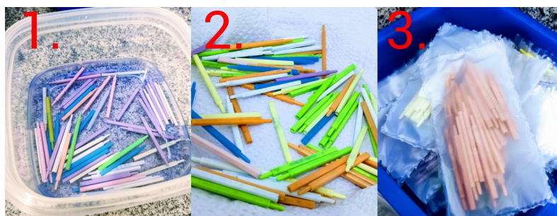
FIGURA 13 - Etapas da esterilização dos lacres para envase a fresco. 1. Lacres de molho em álcool 98°GL; 2. Lacres de envase secando após molho em álcool 70%; 3. Lacres em camada dupla de sacos plásticos de polipropileno esperando para serem autoclavados.
