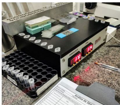
FIGURA 3 - Placa aquecedora e eppendorfs contendo amostras de sêmen incubado para a realização da TTR.
