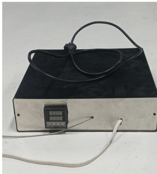
Figura 9 – Imagem frontal do controlador utilizado. Dentro da caixa preta encontra-se o circuito com o relé de estado sólido.
