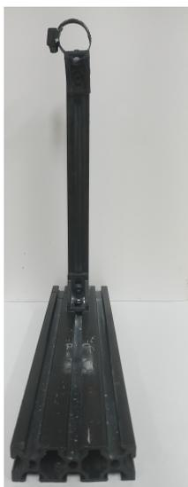
Figura 15 – Suporte de fixação dos corpos cilíndricos.
