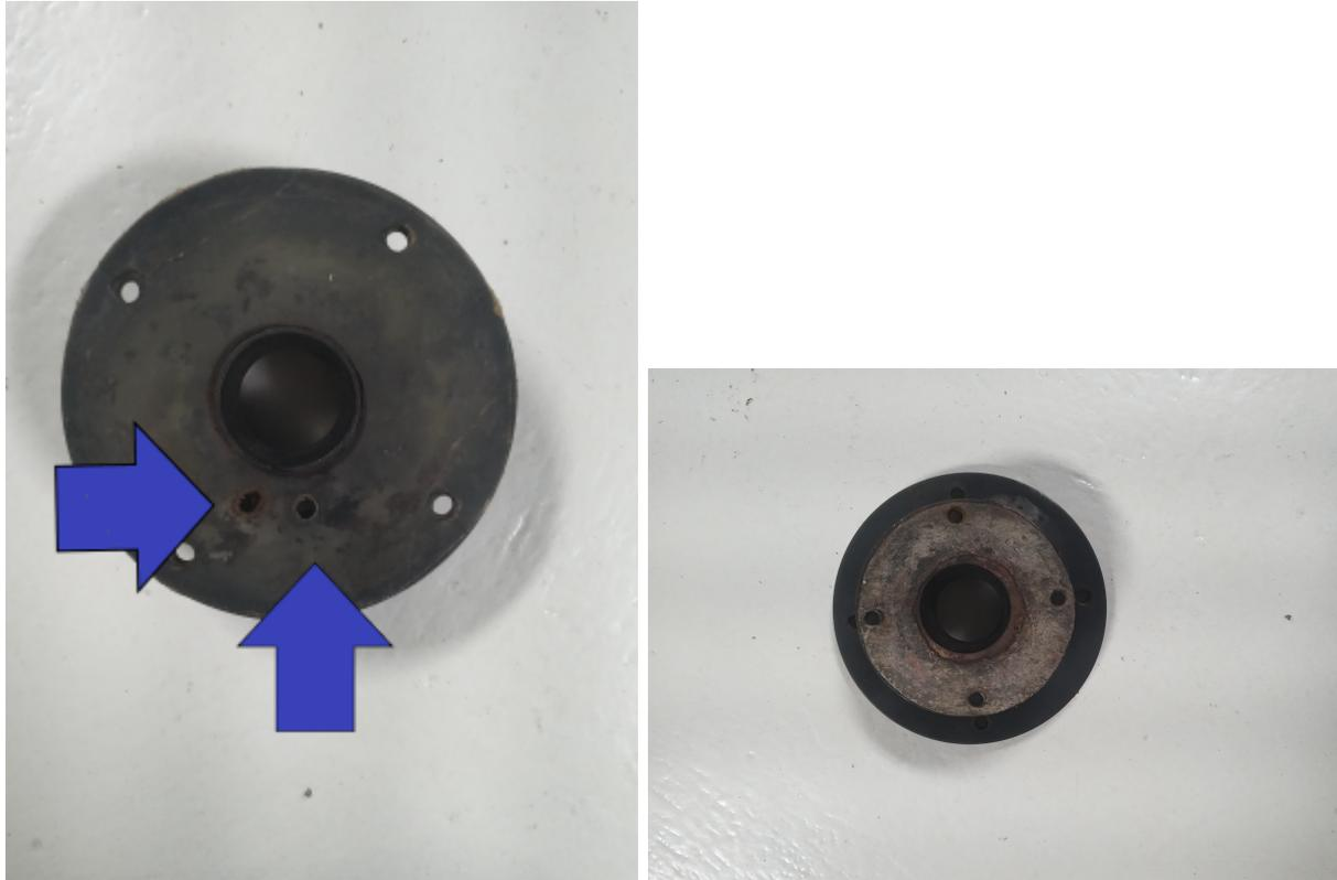
Figura 14 – Suporte utilizado nos primeiros testes. A imagem a esquerda mostra a parte superior da peça, as duas setas indicam os furos os quais o termopar e a resistência cartucho saem. A imagem a direita apresenta a parte inferior da peça o qual esta em contato com a mesa.
