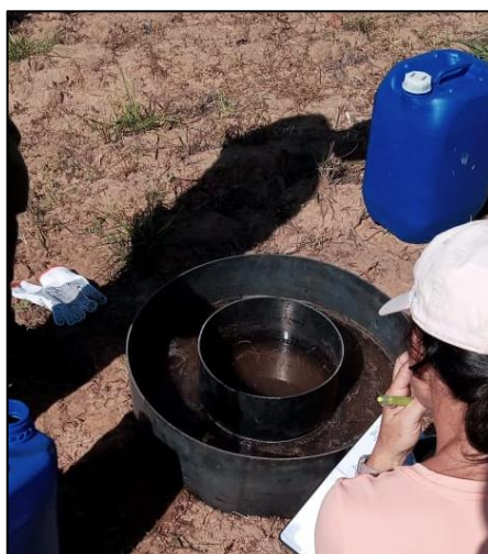
Figura 2 - Teste de infiltração de anéis concêntricos
