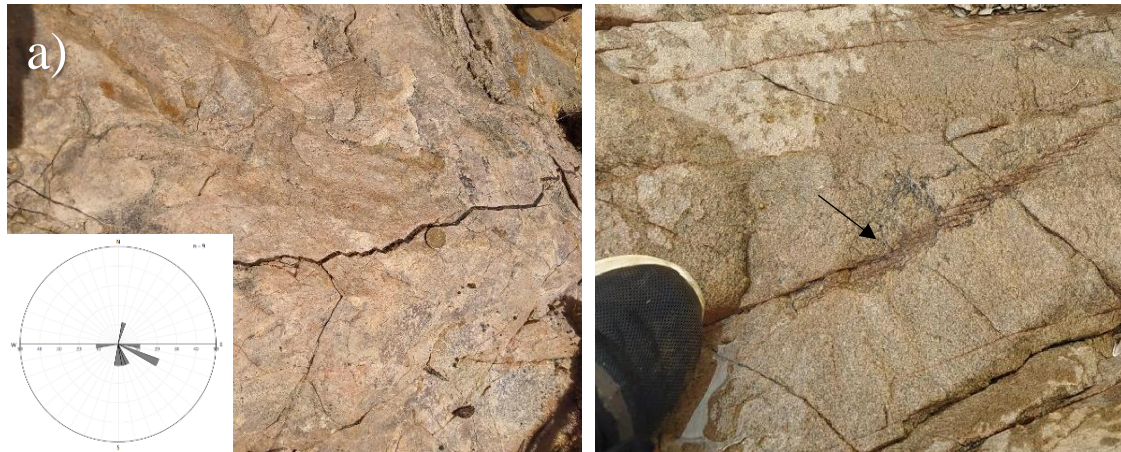
Figura 4.47: a) fraturamentos no granito da Suíte Intrusiva Dona Inês, com diagrama de roseta mostrando as principais direções de fraturas obtidas nos granitos ( n = 9 ); b) Seta preta destacando fraturas escalonadas no granito.
