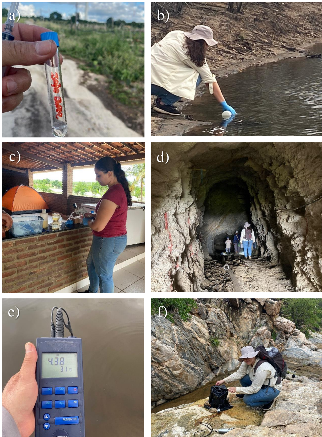
Figura 3.1: a) Coleta de amostras em vials; b) Ambientação de frascos e coleta de amostras de água; c) Filtragem e adição de ácido nas amostras de água; d) Coleta de amostras de água e gás carbônico em mina subterrânea; e) Medição in loco de condutividade e temperatura das amostras de água; f) Medição da concentração de \text{CO}_2 .
