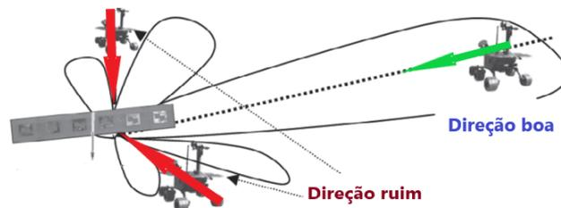
Figura 33 – Se uma onda EM chegar por uma direção de baixa sensibilidade do arranjo de antenas, por exemplo a lateral/transversal, sua intensidade medida será menor do que ao chegar numa direção mais privilegiada. Isso pode ser indesejado no caso de um feixe LOS.
