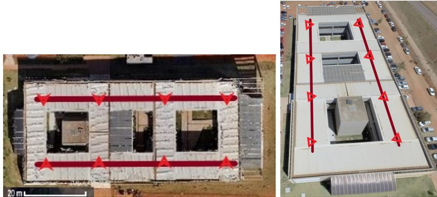
Figura 5 – Cenário pensado para uma implementação inicial do sistema, em algum pavimento do prédio UED na FGA. As duas fitas (representadas por linhas vermelhas e os APs são triângulos) ficariam numa disposição paralela nas paredes das dependências de acesso comum dos corredores.
