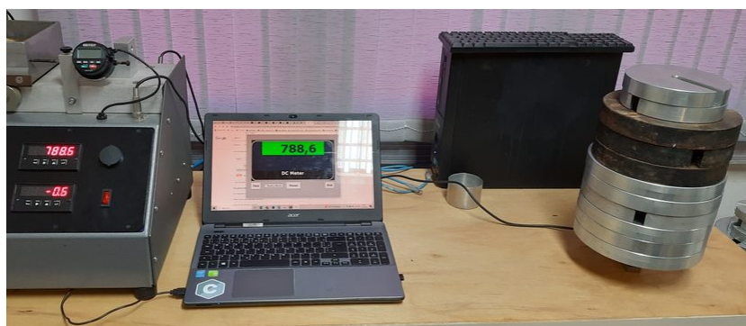
Figura 69 – Teste de Configuração das Células de Carga
