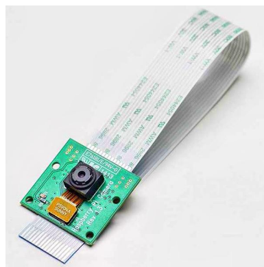
Figura 3.27 – Câmera rev 1.3 e cabo CSI
