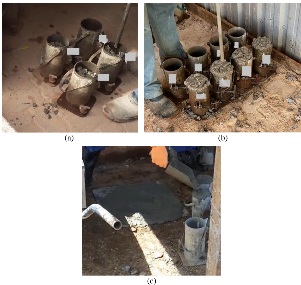
Figura 5.3 – Moldagem dos corpos de prova. Canteiro 01 (a), canteiro 02 (b) e canteiro 03 (c).
