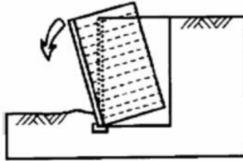
Figura 2.17 Tombamento da estrutura (Gerschovich, 2010).
