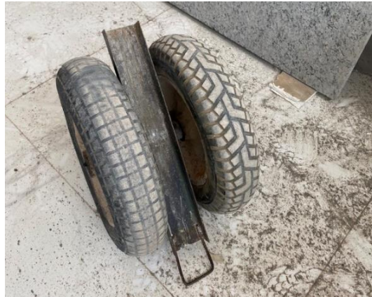
Figura 22 - Carrinho utilizado para transporte de peças de granito nos pavimentos. (Fonte: Acervo pessoal)
