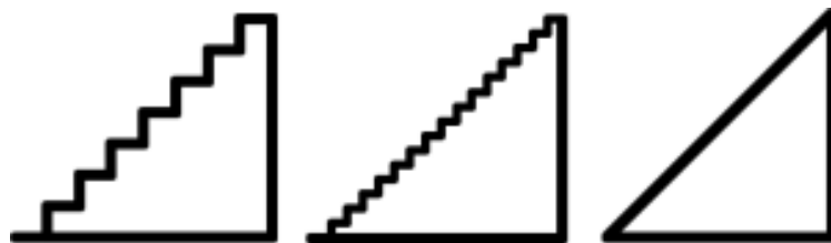
Figura 7 - Analogia Digital (Escada) x Analógico (Rampa).
