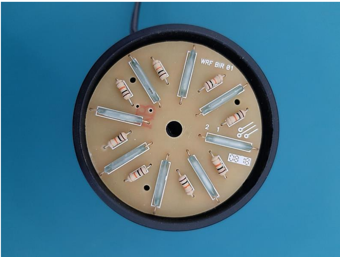
Figura 19 - Módulo de Funcionamento do Indicador de Direção do Vento (USINAINFO, 2022).
