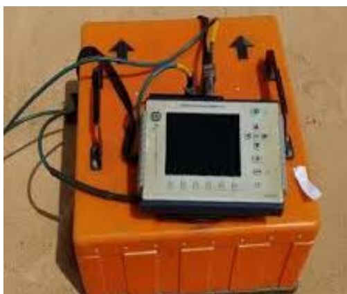
Figura 4.1: Exemplo de antena blindada, e unidade de controle (CORREIA, 2019).
