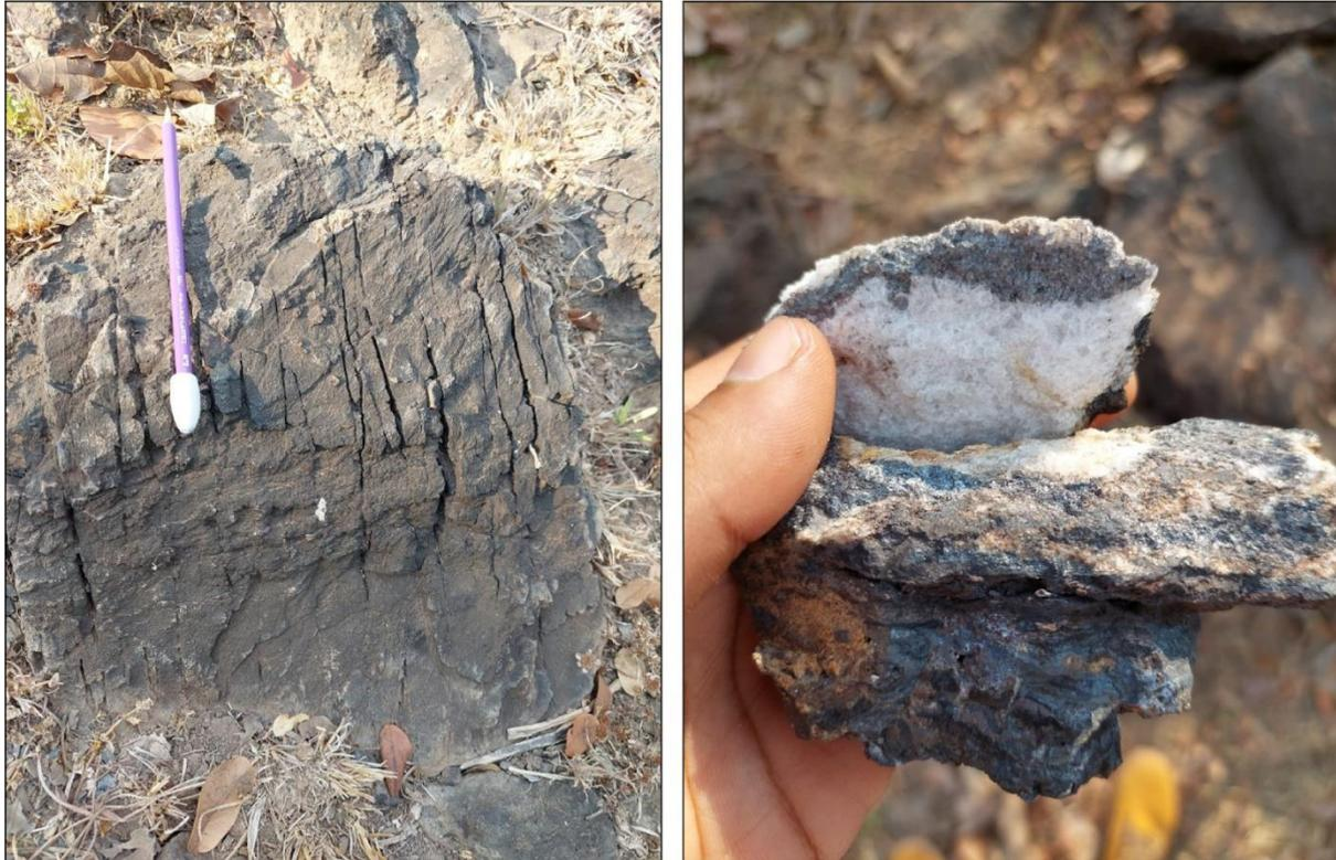
**Figura 7.1:** Exemplos de gonditos expostos na área I. A esquerda um afloramento in situ e a direita amostras de gonditos exibindo óxidos de Fe-Mn (suja as mãos). Afloramento TF22\_I\_1 659422; 844528
