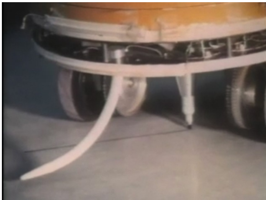
Figura 2 – Pincel acoplado ao robô Turtle para realizar os desenhos através de comandos
