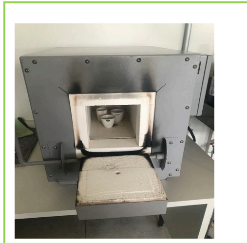
Amostra de cúrcuma em mufla para incineração a 600 °C.
