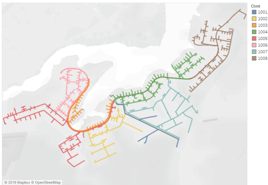
Figura 4.1: Alimentadores de distribuição da subestação número 10 do Lago Sul, DF.
