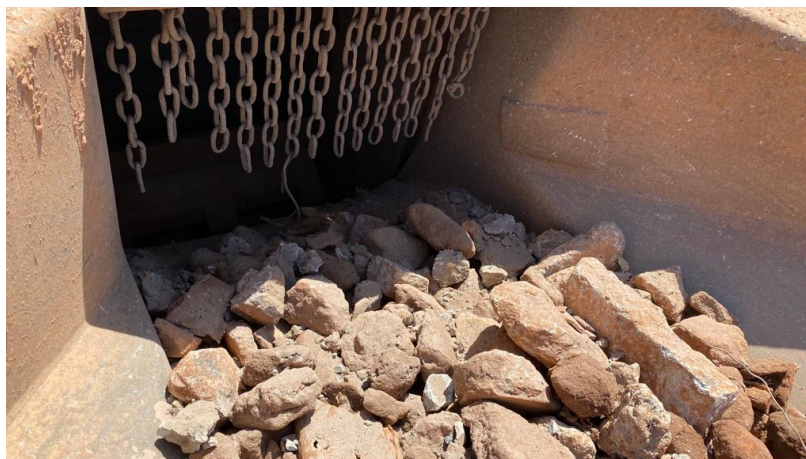
Figura 4.12 – Interior do britador de impacto
