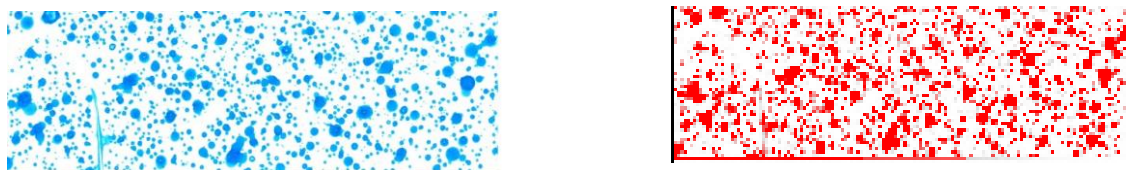
Figura 2. Papel fotográfico sem processamento em azul e em vermelho mesmo papel processado para análise da cobertura.
