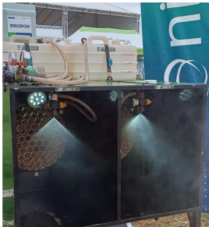
Figura 4. Demonstração visual de efeito do adjuvante em máquina simuladora de deriva, calda com adjuvante e menos deriva (esq.) e calda sem adjuvante e mais deriva (dir.). Fonte: Elaborado pelo autor (2022).
