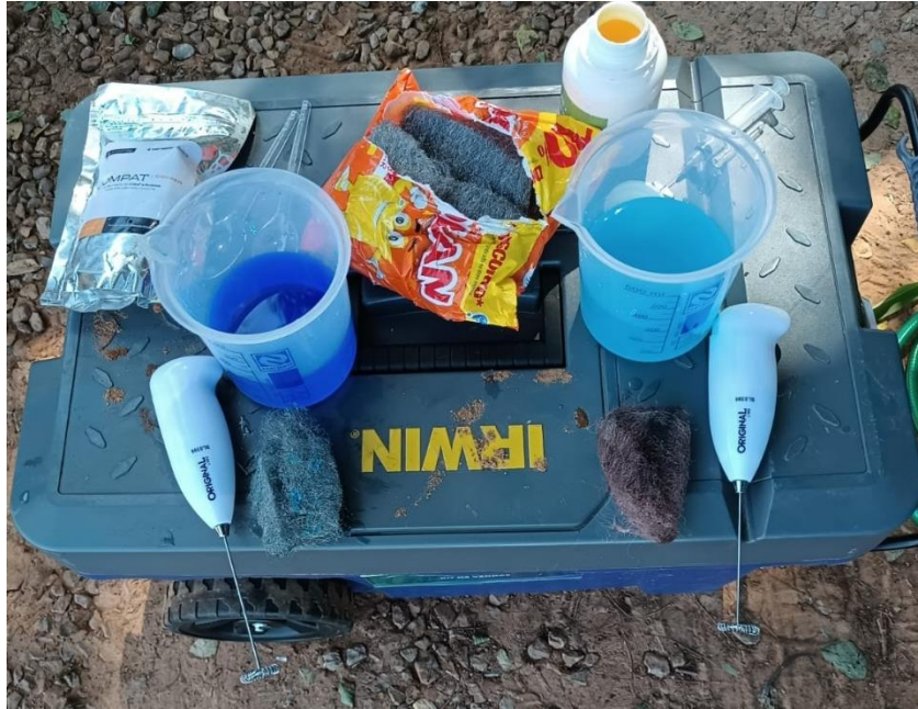
Figura 7. Calda preparada com quelato de cobre (esq.) sem reação com a lã de aço e calda preparada com sulfato de cobre (dir.) mostrando sinais de corrosão na lã de aço. Fonte: Elaborado pelo autor (2022).
