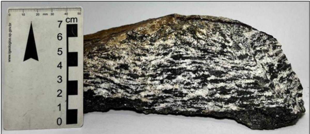
**Figura 5.7:** Foto de amostra de mão com uma amostra representativa de um Bt-Hbl-gnaisse tonalítico da unidade dos Ortognaisses Mara Rosa, com bandamentos milimétricos deformados com geometria dobrada, com bandas félsicas de composição quartzo-feldspáticas e bandas máficas compostas por cristais de biotita e hornblenda.
