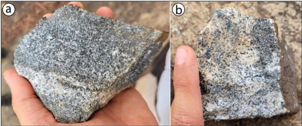
**Figura 5.12:** *Diferentes amostras mesoscópicas coletadas no ponto TF-IV-128. (a) Segregação bem marcada evidenciando uma diferenciação entre uma faixa félsica composta por plagioclásio e quartzo e uma mais máfica, composta por biotita, anfibólio, granada e magnetita. (b) Amostra representativa da porção mais félsica como um todo.*
