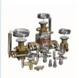
As válvulas de expansão termostáticas regulam a injeção de refrigerante líquido no evaporador. A injeção é controlada pelo superaquecimento do refrigerante. A família de válvulas de expansão termostáticas abrange diferentes válvulas projetadas para aplicações específicas. As válvulas são fornecidas com conexões rosca, solda cobre, solda aço inoxidável ou conexões cobre bimetálico.
