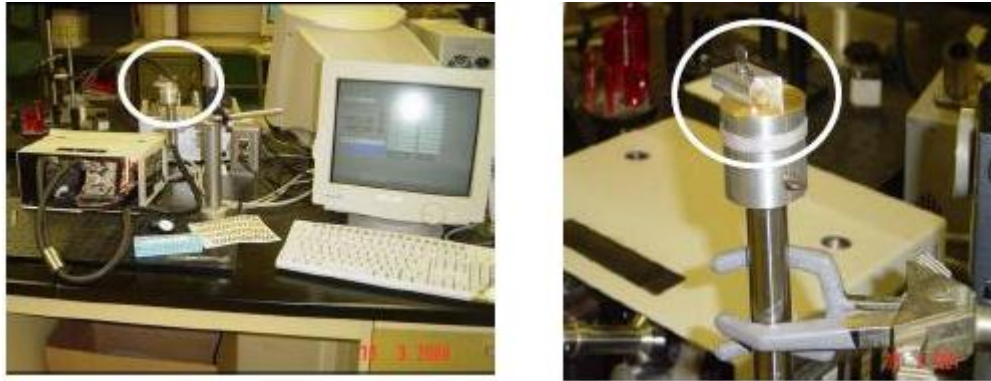
Figura 4.2: Espectrômetro de infra-vermelho próximo utilizado na obtenção dos dados [26]
