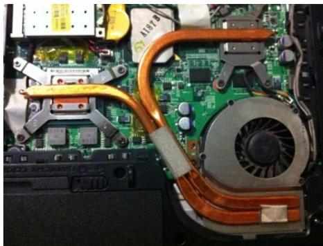
**Figura 1.1** Tubo de calor utilizado em computador
