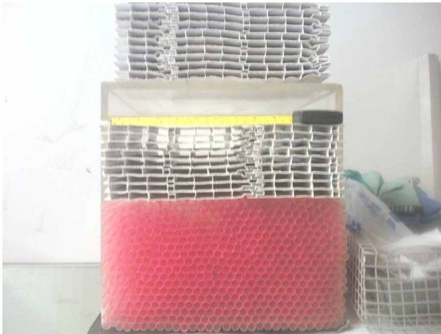
Figura 6 - Condicionadores de escoamento
